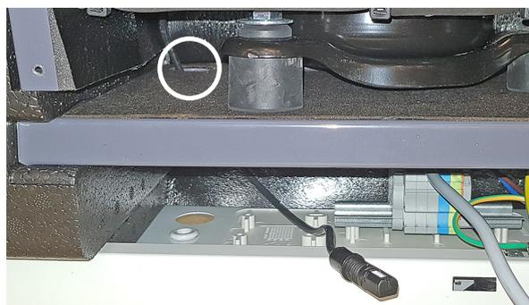
3. Allez chercher le couvercle du compartiment du compresseur avec le support de sonde d'humidité pré-installé.
