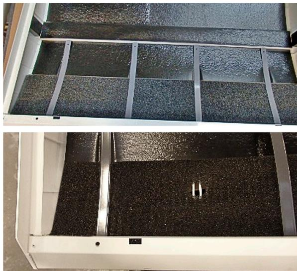
Remarque : pour les CDP/CDF 40 et 50, les filtres doivent être découpés conformément à ce schéma.
